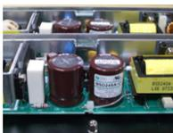
パワードライブ用のメインスイッチング電源。スイッチング電源は、発売当初は出来が悪いものが多かったのですが、最近のものはトランスとブリッジの旧態然の回路より音質的に優れたものが多くなりました。またトランスとブリッジによってパワー段に電源を供給しているパワーアンプのほとんどが、レギュレーターを採用していない為、正確なDC電圧を供給できていませんでした。スイッチング電源は、レギュレートされた大容量のDC電源がパワー段に供給できるというメリットがあり、より高音質を確保できます。
