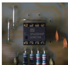
バランス及びアンバランスの入力、そしてプリアンプにはパーブラウン社のオペアンプ OPA2604APを採用。数々のオペアンプを度重なる実験した結果、最も高音質であり採用されました。
