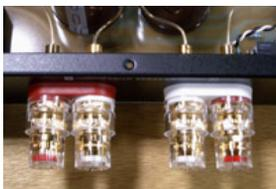
スピーカー出力端子には数々の高級機種に採用されているW B T社の端子を採用しています。ハードワイアリングによる音質劣化を極力避ける為、高音質の金メッキの単線を厳選し、最短距離にて結線されています
