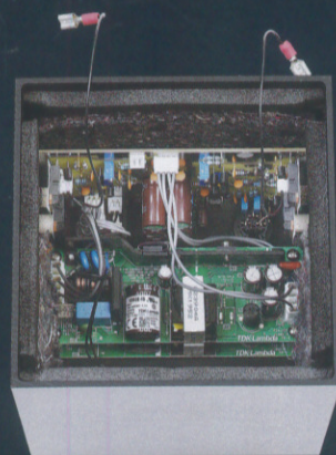
アルミ製エンクロージャーにスイッチング電源とアナログパワーアンプを収めている。吸音材は粗毛フェルト
